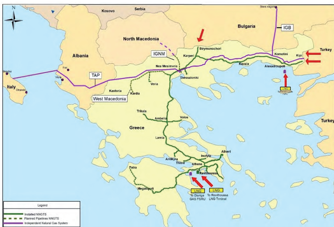
Εικόνα 1 Το ελληνικό σύστημα μεταφοράς φυσικού αερίου.
